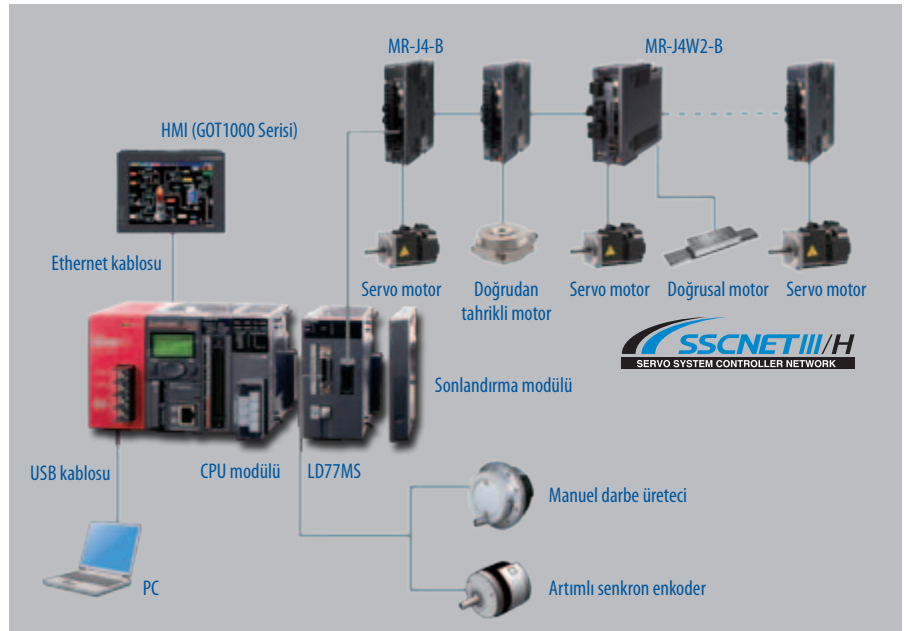
MELSEC L Serisi PLC-CPU ile birlikte servo sürücüler ve servo motorlar içeren bir sistemin yapısı.
